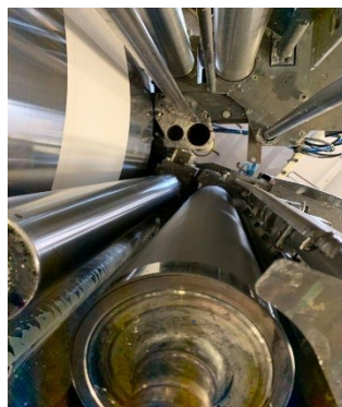
Powlekanie papieru nadającą się do recyklingu i kompostowalną warstwą dyspersyjną
