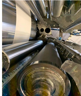
A papír bevonása újrahasznosítható és komposztálható diszperziós bevonó réteggel
